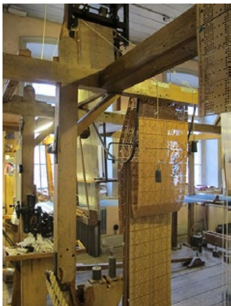
En hålkortsstyrd Jacquardvävstol. Den används än idag i Almgrens sidenväveri, etabl. 1833 i Stock- holm.
