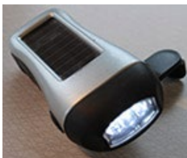
Ficklampa från 2014 med betydligt fler komponenter: Generator kopplad via kuggväxel till veven, laddningsbart knappcells batteri, kretskort, solcell, ledlampor och plasthölje.
