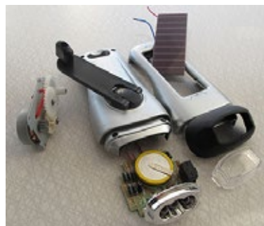
Ficklampa från 2014 med betydligt fler komponenter: Generator kopplad via kuggväxel till veven, laddningsbart knappcells batteri, kretskort, solcell, ledlampor och plasthölje.
